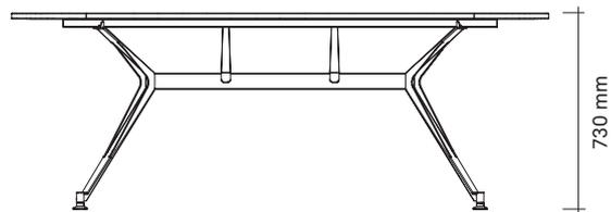
Forme accueillante, détails utiles: LO D11 est équipée d'un patin permettant de faire glisser la table presque sans effort sur les moquettes, les parquets et le béton. Pour les sols irréguliers, un nivellement est possible jusqu'à 20 mm, il est intégré au design et accessible par le haut. L'électrification bien pensée permet de mettre de l'ordre sur et sous la table.
